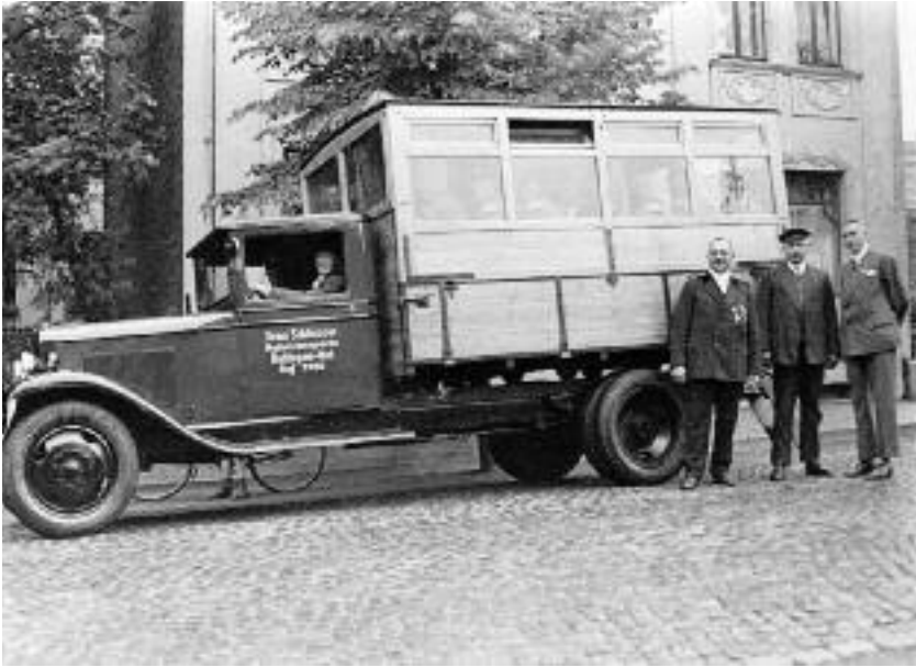
Für den Fuhrunternehmer Jean Schlösser (genannt „Spuk-Schlösser“, da er auch einen Leichenwagen besaß) wurde ein LKW-Aufbau hergestellt, auf dem man wochentags Lasten transportierte. Sonntags wurde für Ausflugsfahrten eine geschlossene Kabine mit Fenstern aufgesetzt. Vor dem Wagen (von links) Wenders, Jean Schlösser, W. Köntgen. Im Wagen vermutlich das Tambourkorps der Johann-Wilhelm-von-Berg-Kompanie
